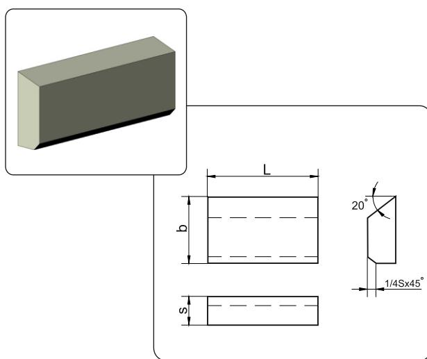
Применяются для дисковых концевых фрез и торцово-цилиндрических фрез к агрегатным станкам
