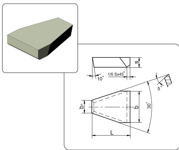
Применяются для резцов при нарезании трапециoidalной резьбы
