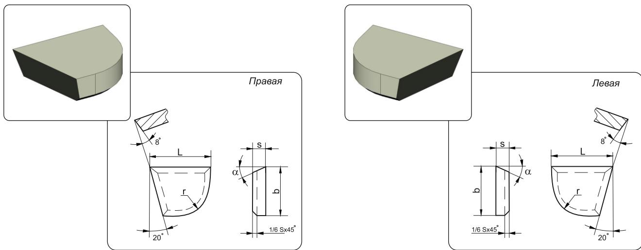
Применяются для подрезных и расточных резцов при расточке глухих отверстий
