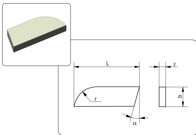
Применяются для дереворежущих пазовых и концевых фрез
