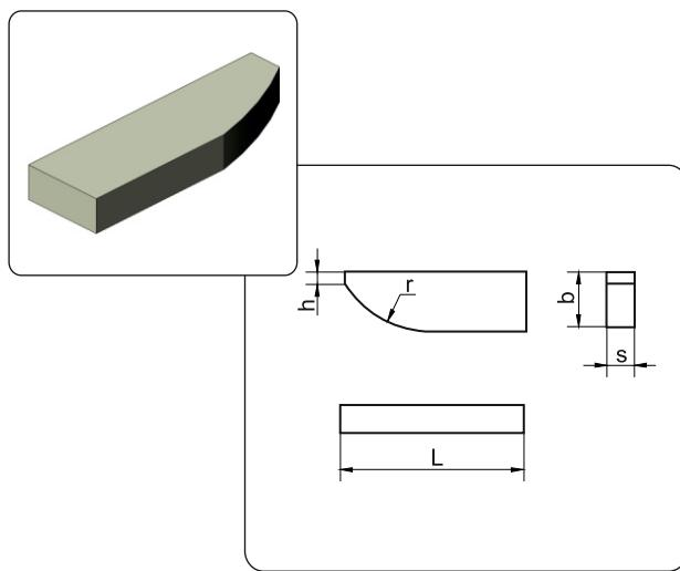
Применяются для концевых и шпоночных фрез, для зенкеров при обработке глухих отверстий и цековок
