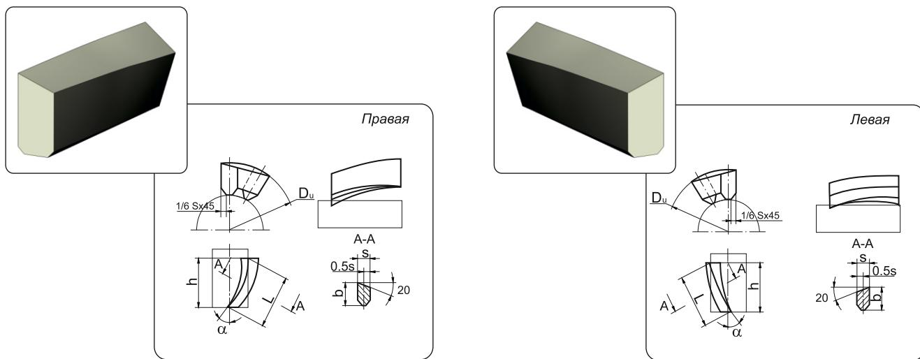
Применяются для торцевых, насадных и концевых фрез со спиральным зубом
