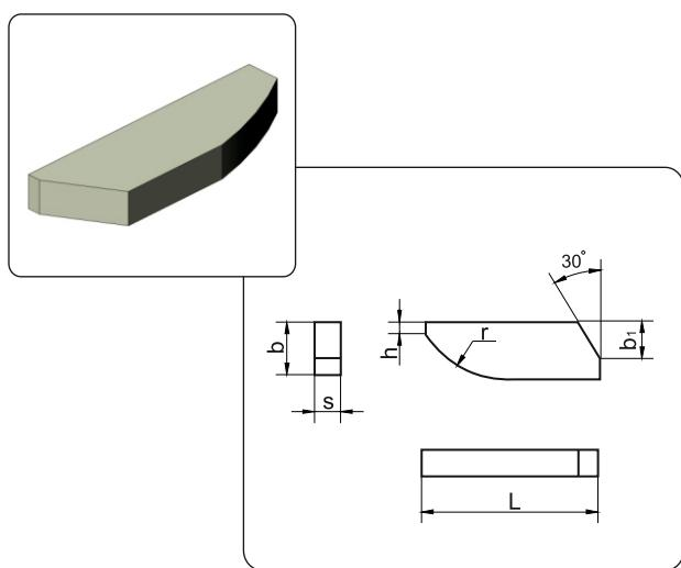
Применяются для зенкеров при обработке сквозных отверстий
