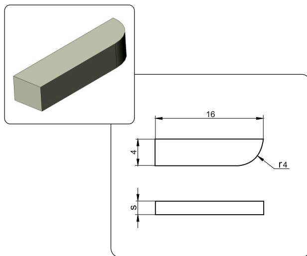
Применяются для токарных проходных и отрезных резцов к автоматам продольно-фасонного точения
