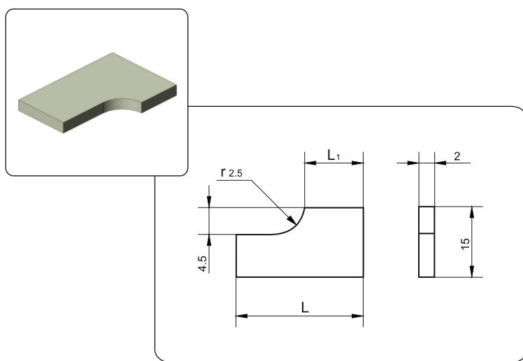
Применяются для деревообработки, для ножей к сборным фасонным фрезам
