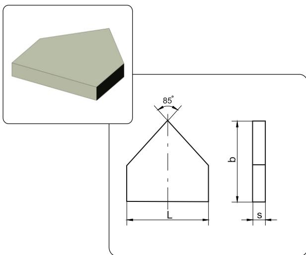
Применяются для сверл при обработке неметаллических материалов
