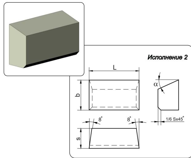
Применяются для проходных, расточных и револьверных резцов
