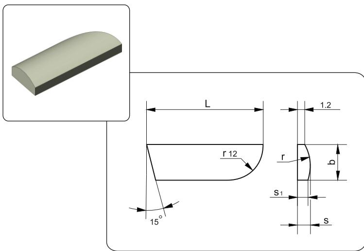
Применяются для деревообработки, для однозубых концевых фрез
