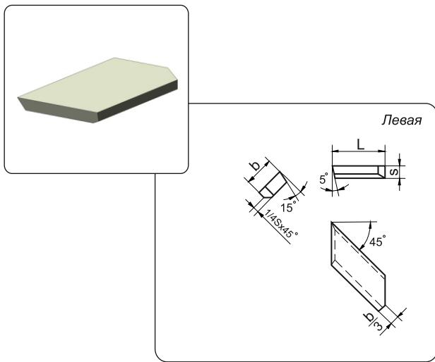
Применяются для фасонных резцов и резцов для обработки пазов типа "ласточкин хвост"
