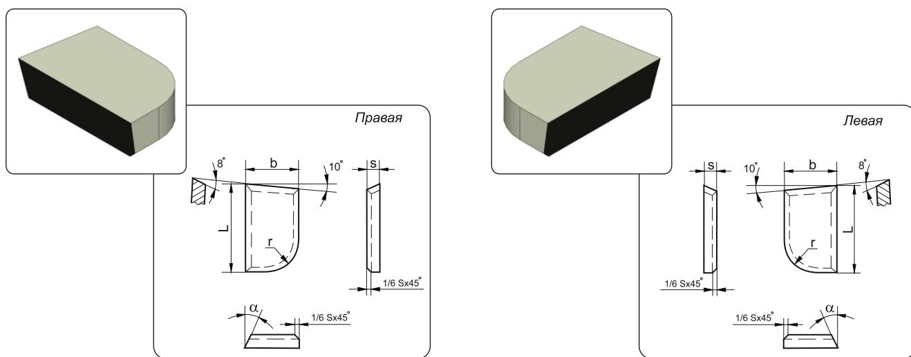
Применяются для проходных, подрезных, расточных и револьверных резцов
