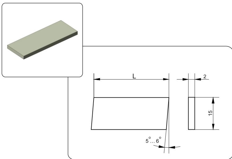
Применяются для деревообработки, для ножей к сборным фасонным фрезам
