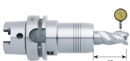
3D 处刀具径向跳动 3um 以下，大幅度提高表面光洁度和刀具寿命。刀体动平衡：G2.5; 20000rpm，最高转速：30000 rpm。
