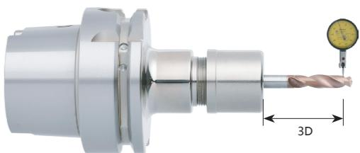
3D 处刀具径向跳动 5um 以下，大幅度提高表面光洁度和刀具寿命。刀体动平衡：G2.5; 25000 rpm，最高转速：45000 rpm。
